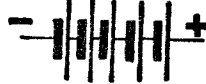
FIG. 4 — Bateria de pilhas, formada de várias pilhas comuns, bem como o respectivo símbolo.
